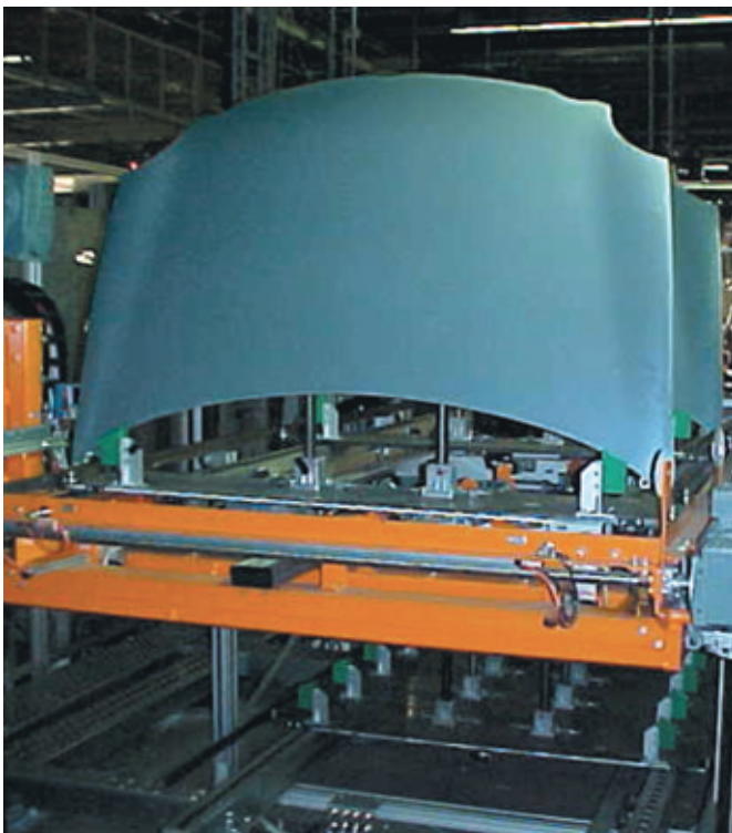
Übergabe vom Staukettenförderer auf den Heber Transfer from accumulating chain conveyor to lifting device
