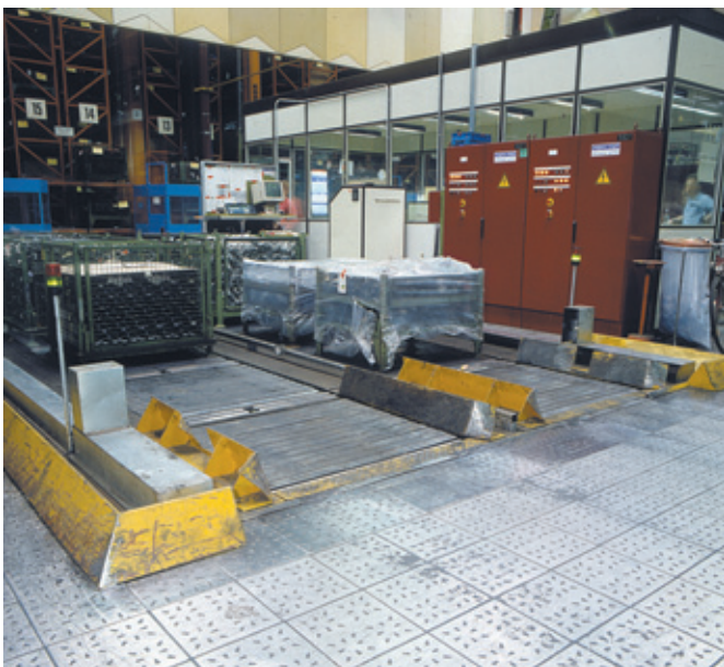
DaimlerChrysler, Hamburg: Plattenbandförderer und Wiegeeinrichtung DaimlerChrysler, Hamburg: Plate conveyor and weighing unit for goods receipt
